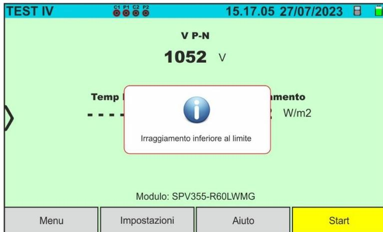
Wenn das Gerät bei aktiver und verbundener Fernstation (auch während der Aufzeichnung) einen Einstrahlungsstärkewert unterhalb des Grenzwertes (siehe § 5.2) feststellt, bricht es den Test ab und kehrt zum Hauptbildschirm zurück.
