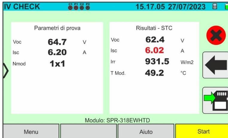
Abb. 59: Beispiel für negatives Ergebnis IVCK-Test – STC-Werte
