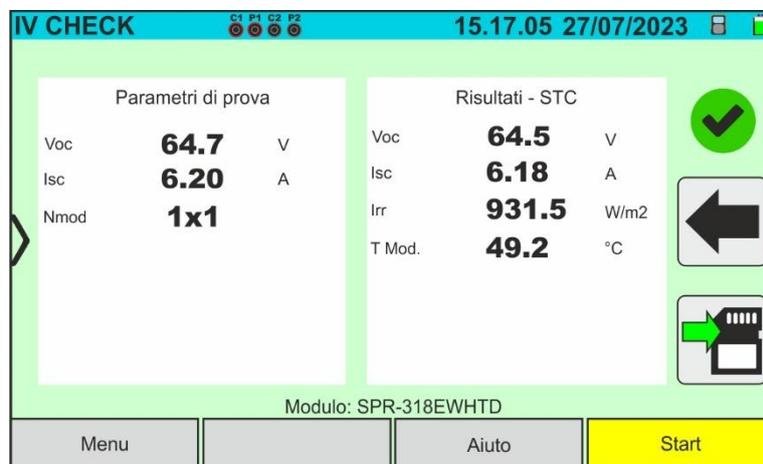
Abb. 58: Beispiel für positives Ergebnis IVCK-Test – STC-Werte
