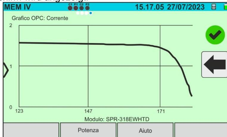
Abb. 76: Abruf der I-U-Kurven-Messergebnisse – @OPC-Stromkurve
