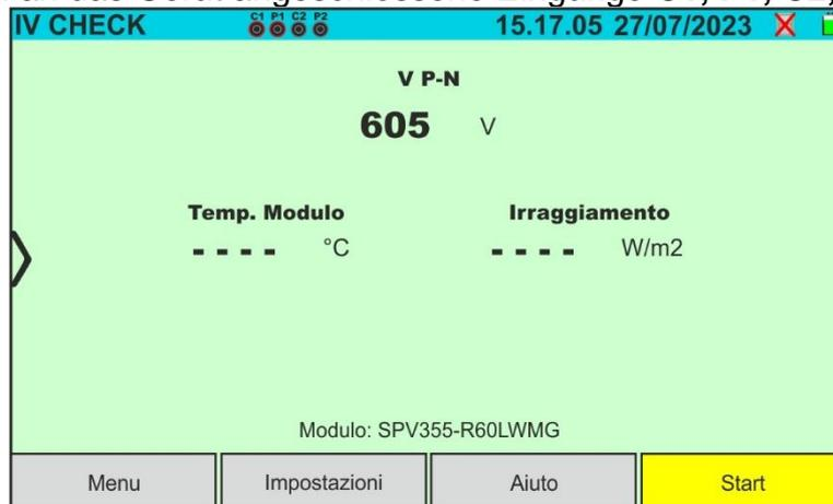
Abb. 46: Startbildschirm IVCK-Test ohne Fernstation bei einseitigen Modulen
