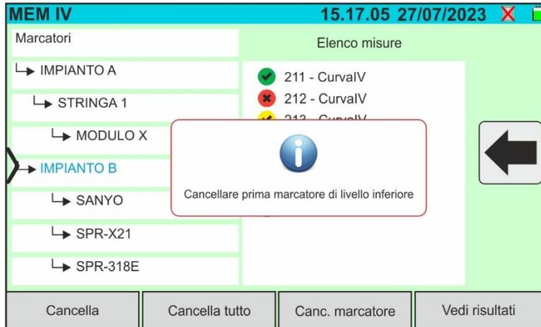
Wenn ein hervorgehobener Marker der ersten Ebene entfernt werden soll, führt das Gerät den Vorgang nicht aus und zeigt die in der nebenstehenden Abbildung dargestellte Meldung an. Entfernen Sie zuerst **alle untergeordneten Marker**.
