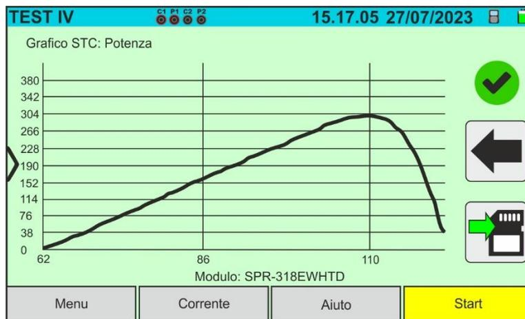
Abb. 40: Beispiel für das Ergebnis einer Leistungsmessung – STC-Kurve
