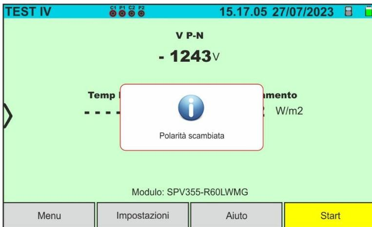
Wenn das Gerät eine Spannung  $<-0,5VDC$  an den P-N-Klemmen des Strings feststellt, führt es den Test nicht durch, gibt einen langen Piepton aus und zeigt die Meldung „Polarität vertauscht“ an.
