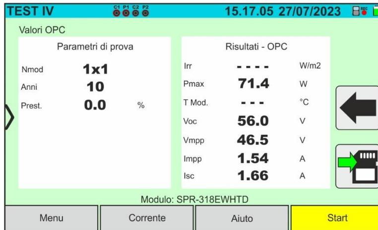
Abb. 43: Ergebnis der I-U-Kurvenmessung @OPC mit synchroner Aufzeichnung
