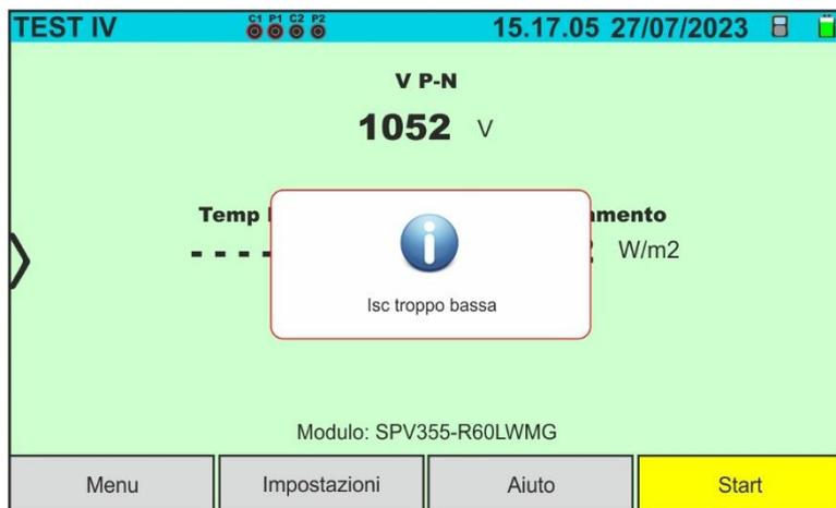
Wenn das Gerät einen Kurzschlussstrom **Isc unterhalb eines Grenzwertes** feststellt, führt es den Test nicht durch und zeigt die Meldung „Isc zu niedrig“ an. Überprüfen Sie die Anschlüsse des Geräts und die Funktion des Moduls/Strings.
