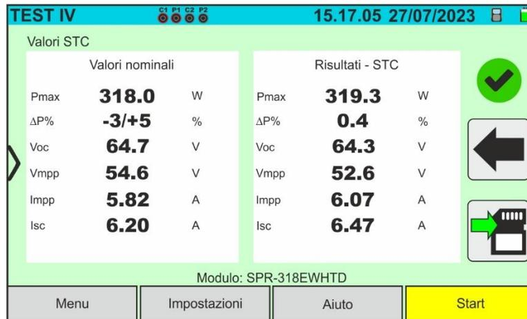
Abb. 37: Beispiel für das Ergebnis einer I-U-Kurven-Messung – STC-Werte
