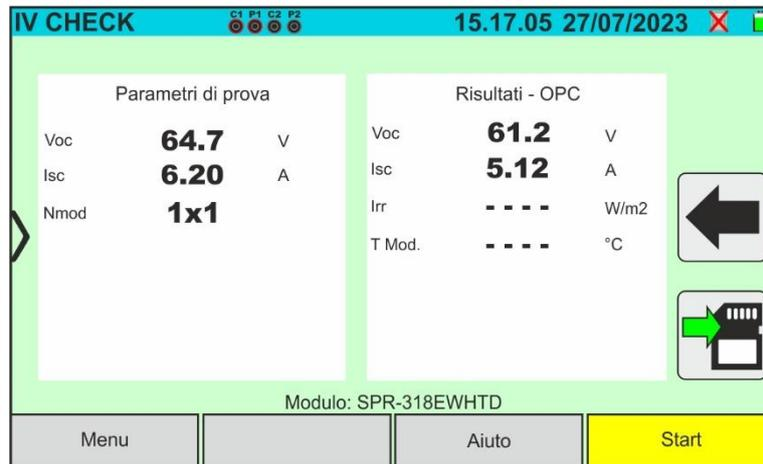
Abb. 60: Messergebnis IVCK @OPC-Test mit synchroner Aufzeichnung
