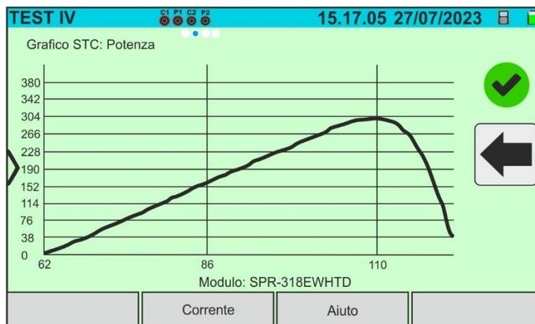
Abb. 74: Abruf der I-U-Kurven-Messergebnisse – @STC-Leistungskurve
