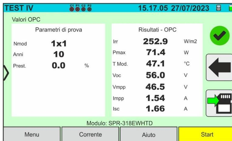
Abb. 38: Beispiel für das Ergebnis einer I-U-Kurven-Messung – OPC-Werte
